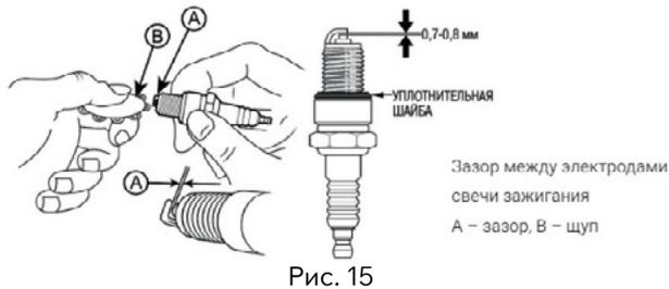
**ВНИМАНИЕ!** Свеча зажигания должна быть надежно затянута. Не затянута должным образом или чрезмерно затянута свеча зажигания может привести к повреждению двигателя.
