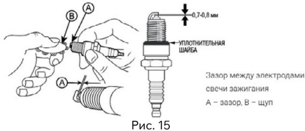
**ВНИМАНИЕ!** Свеча зажигания должна быть надежно затянута. Не затянутая должным образом или чрезмерно затянутая свеча зажигания может привести к повреждению двигателя.
