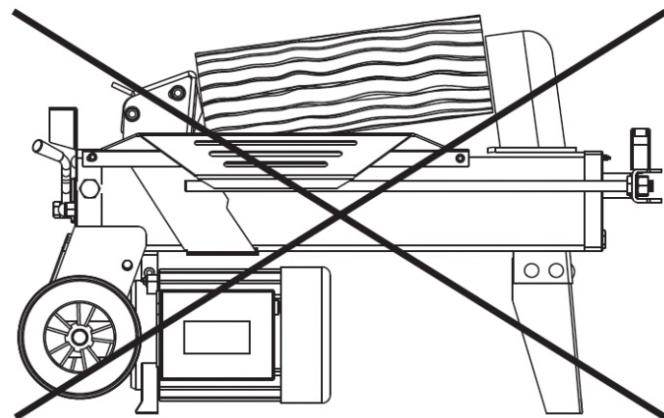
При непрерывной работе гидропривода более 5сек масло под воздействием давления перегревается, и устройство может сломаться. При рубке чрезмерно твердого бревна повернуть его на 90° и проверить, можно ли разрубить его в другом направлении. В любом случае, если разрубить бревно не получается, это означает, что его твердость превышает функциональные возможности устройства, таким образом, во избежание повреждения дровокольного станка необходимо убрать такое бревно.
