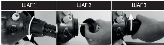
1. Поместите прозрачную пластиковую трубку от двигателя в отверстие распылительной трубки (см. изображения). Короткая трубка является воздухозаборником и ни к чему не подключена. Убедитесь, что воздухозаборник не загрязнен и не заблокирован. Прикрутите соединитель распылительной трубки к двигателю. Не допускайте перегибания и прокалывание шлангов.
